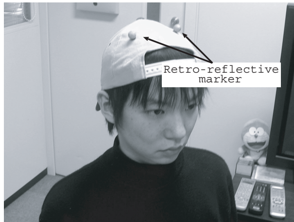
図 4.1 高再帰性反射マーカ
