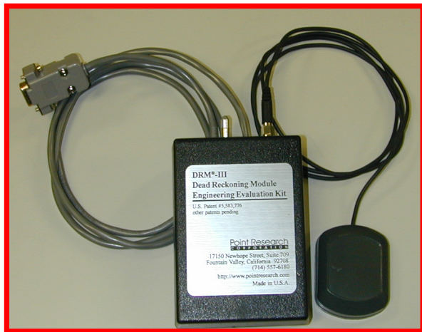
(a) GPSレシーバ付き慣性航法センサ DRM-III (Point Research Corp.)
