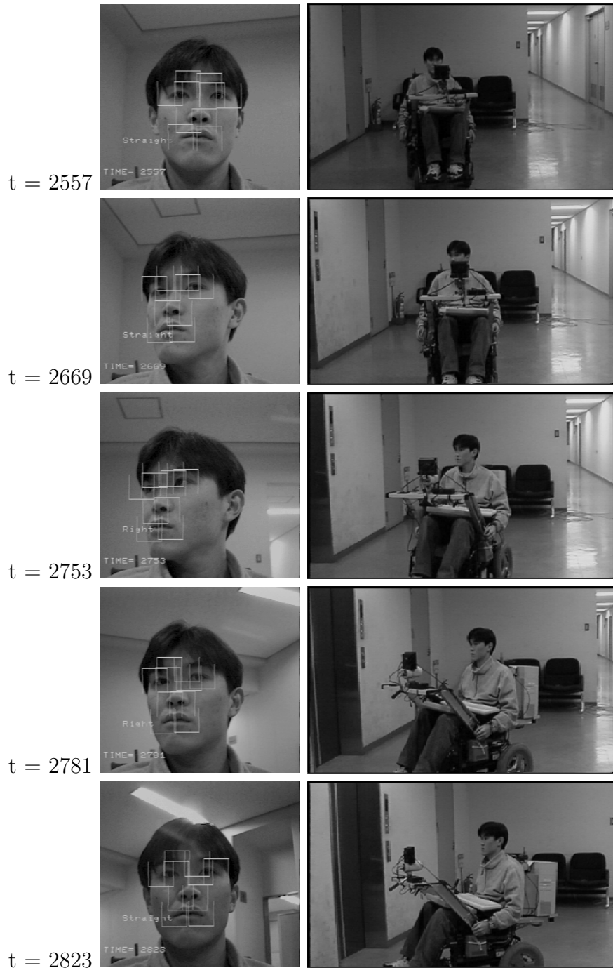
図 2.6 右への移動 . 顔の向きとロボットの動き ( t = 2557 ~ 2823 )
