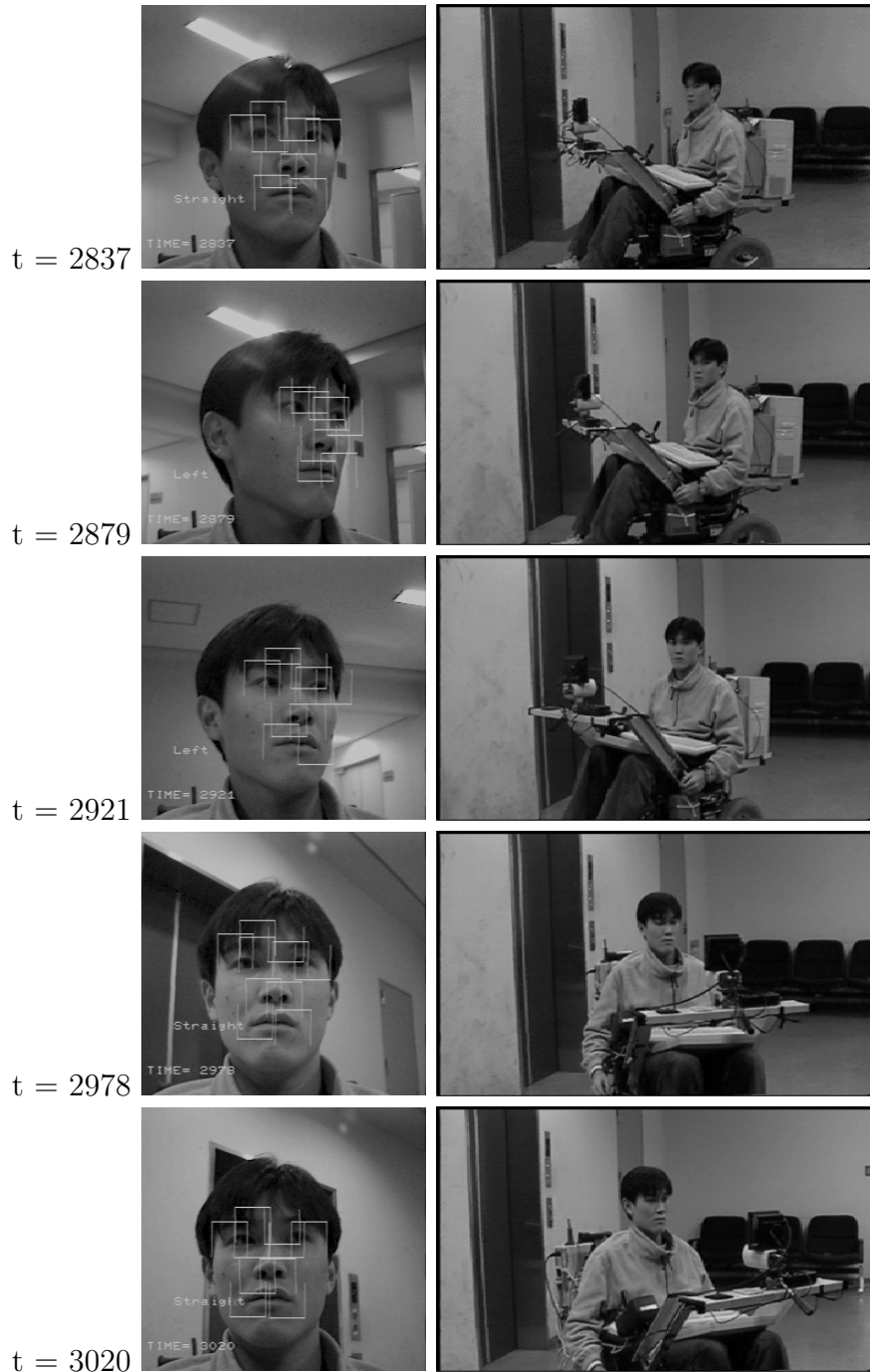
図 2.7 左への移動 . 顔の向きとロボットの動き ( t = 2837 ~ 3020 )
