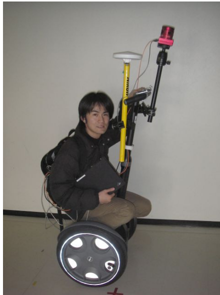
図 39 全方位型マルチカメラシステムと GPS 受信機
