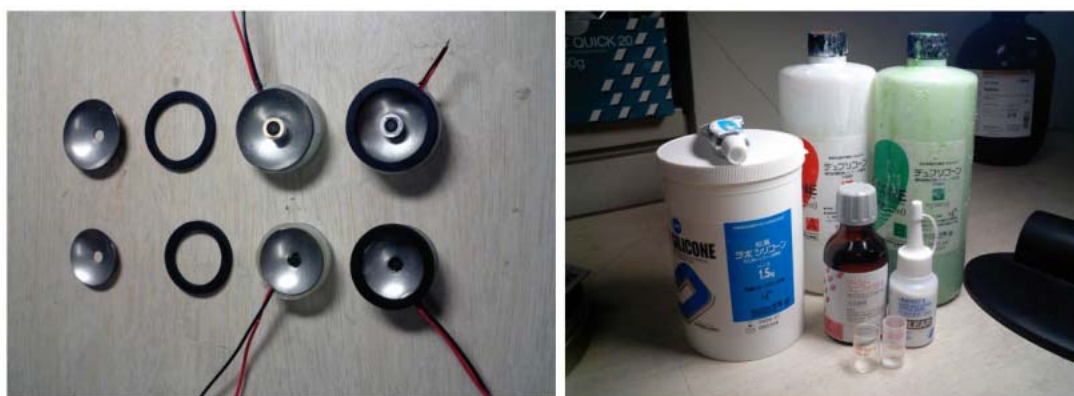
図 3.40 現行 NAM マイクロフォンの構造とその素材
