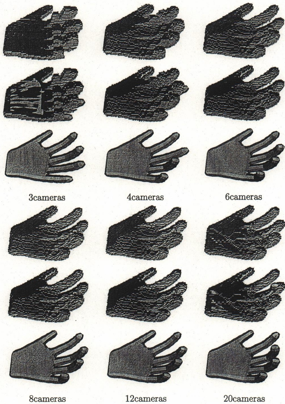
図 5.13 カメラ台数の違いによる手形状推定の結果 (1 段目: ボクセルモデル, 2 段目: ボクセルモデルと推定結果の重畳表示, 3 段目: 推定結果)
