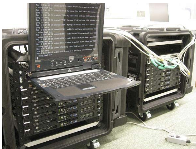
図 2 可搬型小規模ネットワークエミュレーションテストベッド (StarPOD)
