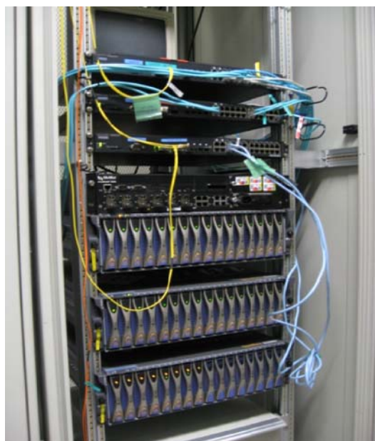
図 2 可搬型小規模ネットワークエミュレーションテストベッド (StarPOD)
