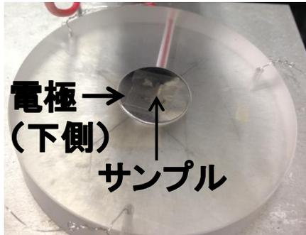
絶縁破壊測定装置
