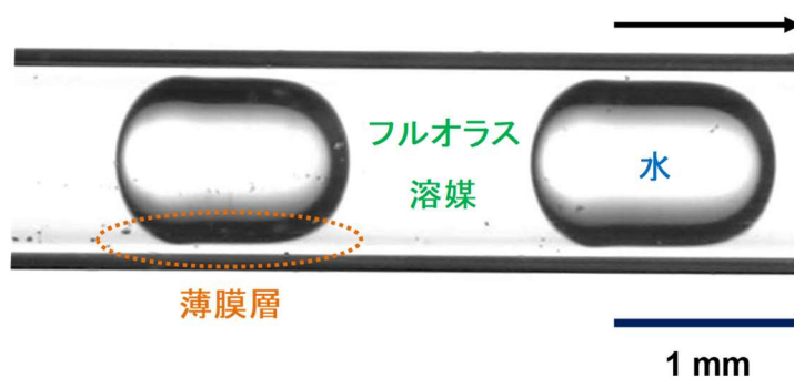
Figure 2-9. チューブ内でのフロー状態の写真(フルオラス溶媒：水)
