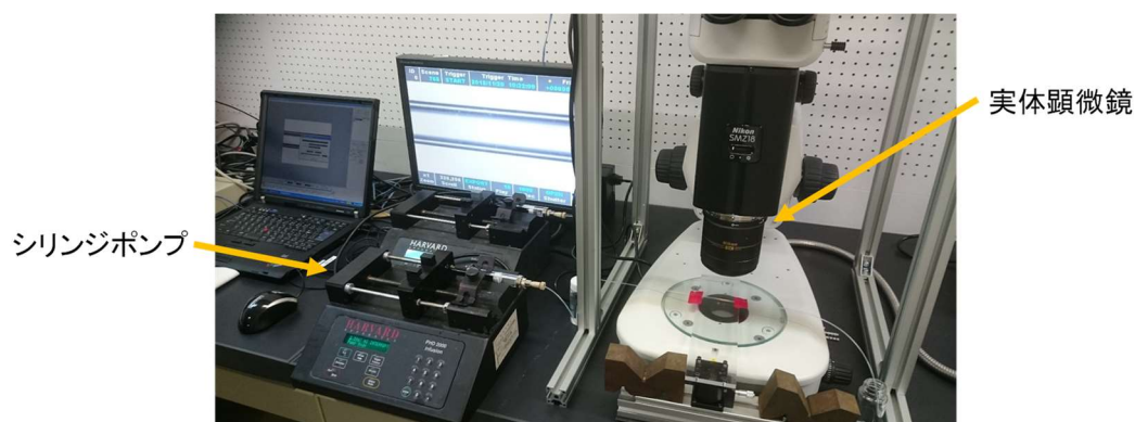
Figure 2-8. ハイスピードカメラを搭載した実体顕微鏡による二相交互流の観察
